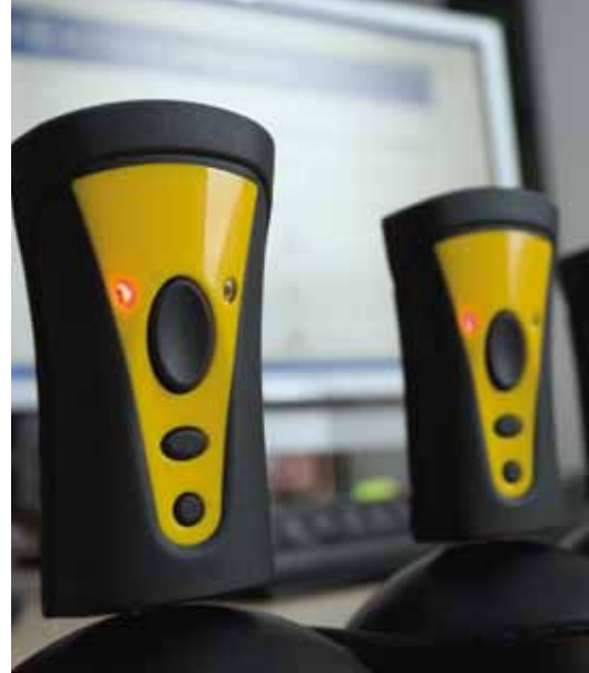
Von der Dockingstation werden die Daten aus dem Scanner in den Computer übertragen
